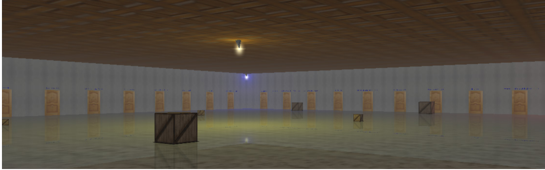
Abbildung 8: Phong Shading: Beim Boden und der Decke handelt es sich um 2 Meshes aus je 2 riesigen Dreiecken. Das Licht ist zentral im Raum. Mit Gouraud Shading wäre der Boden und die Decke unbeleuchtet, wir interpolieren zwischen den Vertices jedoch die Normalen und nicht die resultierende Lichtintensität.
